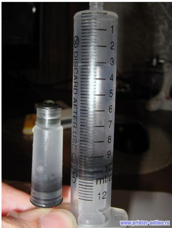
После этого достаньте капсулу из емкости и доведите поршень шприца до конца, набрав в систему воздух. Переверните капсулу насадочным отверстием вверх, а шприц носиком вниз и давлением на поршень заполните капсулу на 1/3 промывочной жидкостью. В таком состоянии аккуратно насадите капсулу на чернилозаборную иглу промываемого канала
