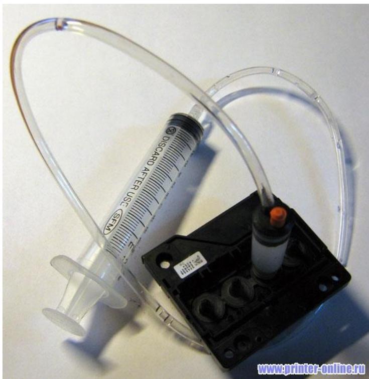
Отрежьте от капельницы сплошной кусок трубки, длиной примерно 20-30 см - для дальнейшего удобства работы. С помощью фена или горячей воды плотно насадите один конец трубки на носик шприца:
