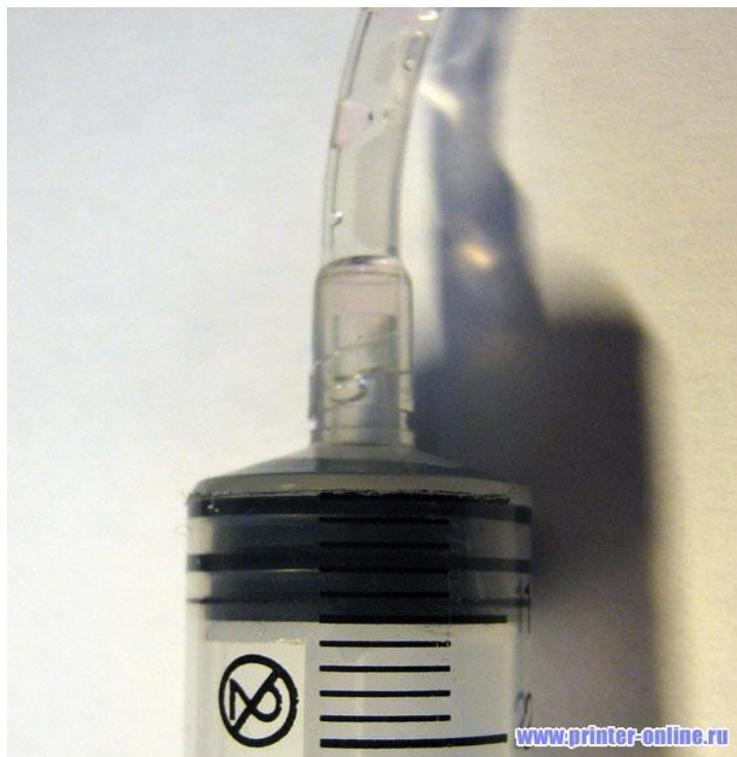
С помощью сверла диаметром 4 мм расширьте отверстие в верхней манжете капсулы, чтобы можно было с натягом вставить второй конец трубки от капельницы внутрь этого отверстия. Для этого манжету можно хорошо разогреть в горячей воде, после чего вставить конец трубки. Трубка должна входить в манжету с натягом - т.е. очень плотно, на всю длину манжеты. Перед вставкой трубки в манжету не забудьте тщательно промыть манжету от резиновой стружки, которая образуется от разворачивания отверстия сверлом.
